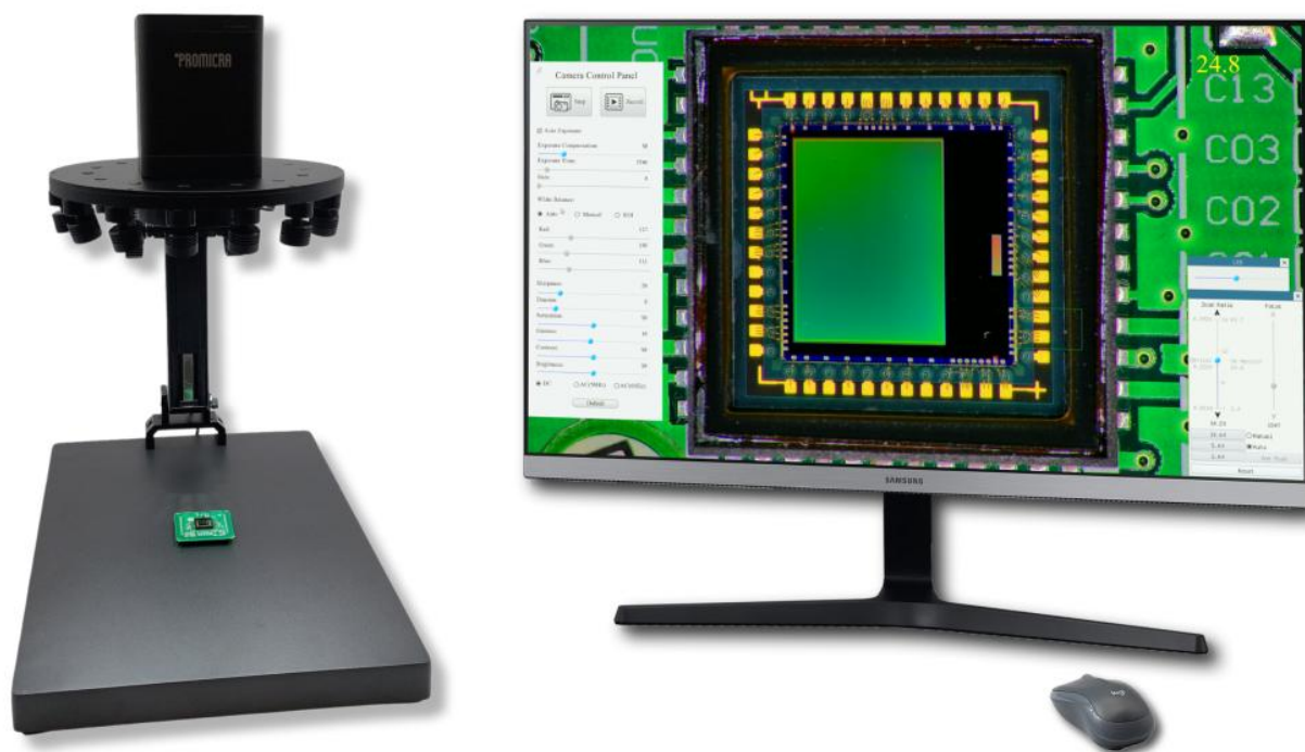
PRO-18 AF 4K s volitelným LED osvětlovačem PRO-LDRL pro velké vzorky a 4K UHD monitorem
